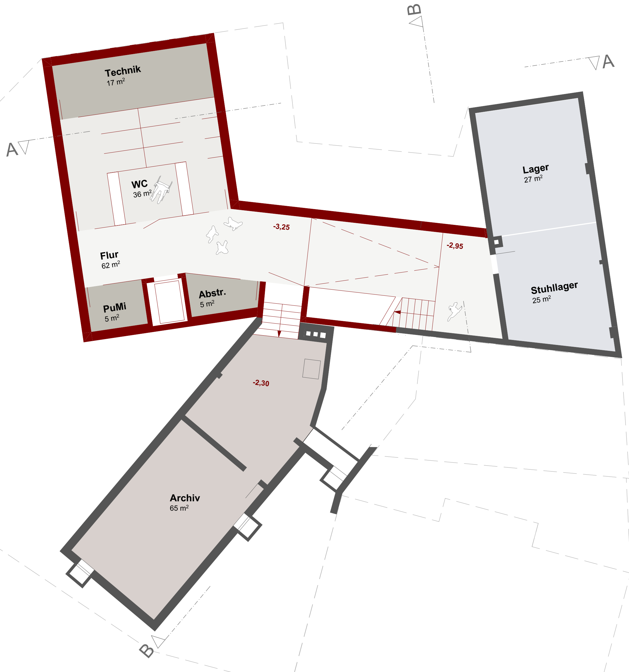
Archiv, WC, Lager, Technik _ Untergeschoss 1:100
