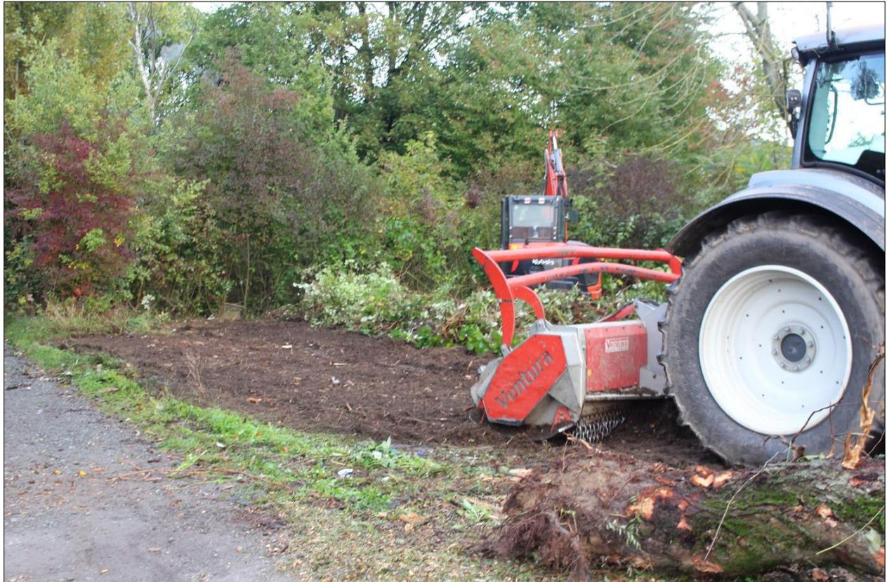
**Abbildung 2:** Freilegen der Fläche mit Greifer und Forstmulcher
